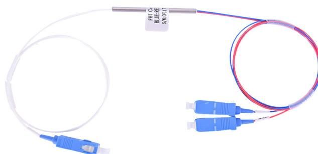
Splitter óptico 1x2 desbalanceado conectorizado no padrão SC/UPC. Tem a função de fazer a divisão do sinal óptico proveniente de uma fibra óptica para duas, em uma proporção de 25% do sinal para uma fibra e 75% para outra.
